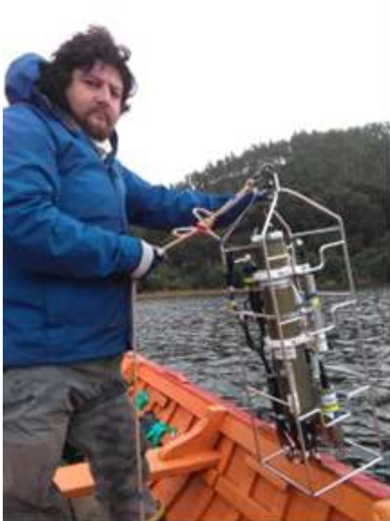
Figura 2. Perfilador hidrográfico CTD-OF SBE25.
